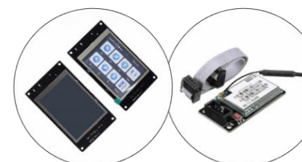
نمایشگر رکنی لمسی ۲ و ۳ اینچ با SD کارت و ماژول WiFi
